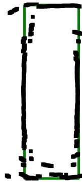
Figura 4.7: Identificação das dimensões do tanque por meio da imagem gerada pelo sonar
